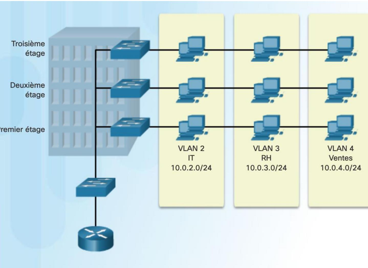
Les VLAN permettent à un administrateur de segmenter les réseaux en fonction de facteurs tels que la fonction, l'équipe de projet ou l'application, quel que soit l'emplacement physique de l'utilisateur ou du périphérique. Chaque VLAN est considéré comme un réseau logique distinct. Les appareils d'un VLAN se comportent comme s'ils se trouvaient chacun sur leur propre réseau indépendant, même s'ils partagent une infrastructure commune avec d'autres VLAN.
