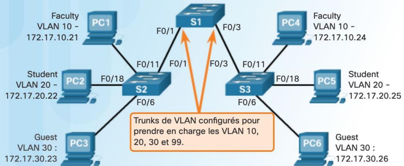
Une agrégation est une liaison point à point entre deux périphériques réseau qui porte plusieurs VLAN. Un trunk de VLAN permet d'étendre les VLAN à l'ensemble d'un réseau. Cisco prend en charge la norme IEEE 802.1Q pour la coordination des trunks sur les interfaces Fast Ethernet, Gigabit Ethernet et 10 Gigabit Ethernet.
