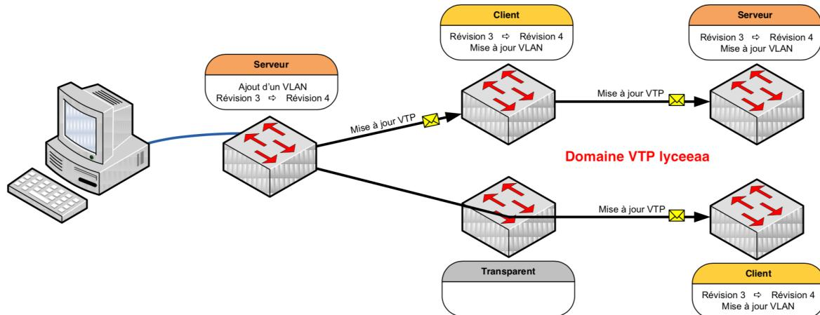
VTP fonctionne sur les commutateurs Cisco dans un de ces 3 modes : **Serveur, Client ou Transparent**
